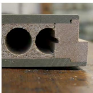
Anta cieca dello spessore di mm 53 composta da spalle perimetrali di legno duro, per una buona tenuta delle cerniere, riempita in truciolare forato, con due pannelli in MDF di mm 9 ca. caduno, impiallacciata con tranciato a richiesta o laccata.
