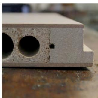
Anta cieca dello spessore di mm 44 composta da spalle perimetrali di legno duro, per una buona tenuta delle cerniere, riempita in truciolare forato, con due pannelli in MDF di mm 4 ca. caduno, impiallacciata con tranciato a richiesta o laccata.
