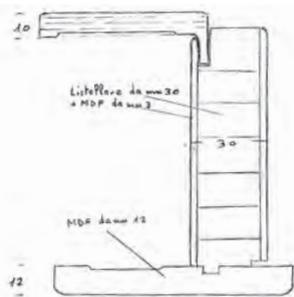
Telaio con stipite e coprifilo in pezzo unico (prodotto artigianale) con tre cerniere a scomparsa (serratura a calamita compresa) complanarità parte a spingere.
