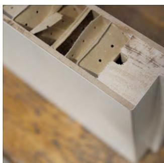
Anta cieca o finestrata dello spessore di mm 44 composta da spalle perimetrali di legno duro, per una buona tenuta delle cerniere, riempita a nido d'ape semiresinato, tamburata con due pannelli in MDF di mm 4 ca. caduno, impiallacciata con tranciato a richiesta o laccata.
