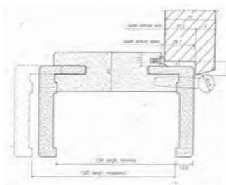
Telaio telescopico con anuba fissate direttamente sul coprifilo.
