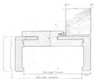
Telaio telescopico con tre cerniere a scomparsa (serratura a calamita compresa) complanarità parte a tirare.
